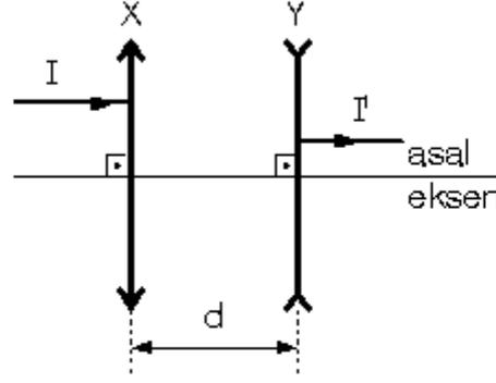
İnce kenarlı X merceği ile kalın kenarlı Y merceği şekildeki gibi yerleştiriliyor. X, Y merceklerinin arasındaki uzaklık  $d$ , odak uzaklıkları da sırasıyla  $f_x$ ,  $f_y$  dir.
