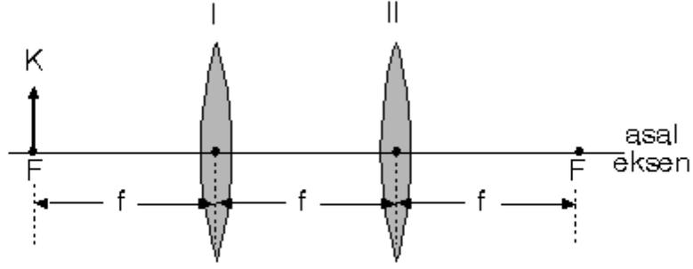
İnce kenarlı özdeş iki mercek, şekildeki gibi yerleştirilmiştir. F odak noktasına konulmuş K cisminin, bu sistemdeki görüntüsünün boyu h, cisme uzaklığı d dir.
