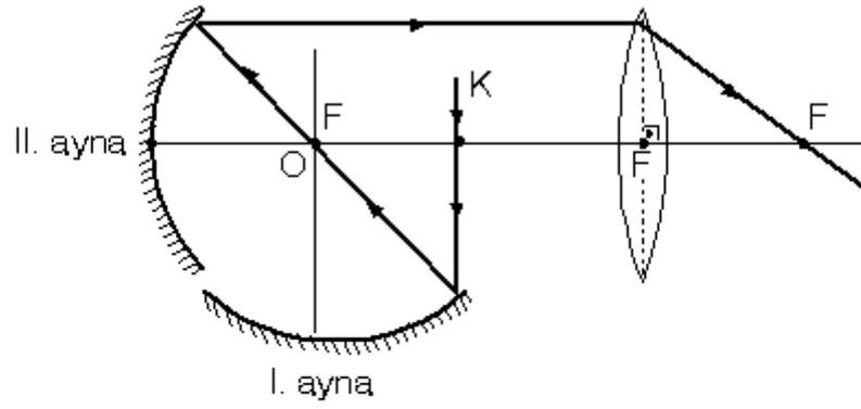
Çukur aynanın asal eksenine paralel olarak gelen ışık odaktan, odaktan gelen ışık ise asal eksene paralel yansır.
