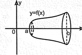
$y=f(x)$  eğrisi  $x=a$ ,  $x=b$  doğruları ve x eksenini ile sınırlanan şekildeki taralı bölgenin x eksenini etrafında  $360^\circ$  dönmesiyle oluşan dönel cismin hacmi,
