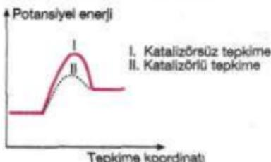
Bir tepkimenin oluşumunun basamaklar halinde gösterilmesine **tepkime mekanizması** denir. Tepkimenin hızı mekanizmadaki en yavaş adının hızına bağlıdır.
