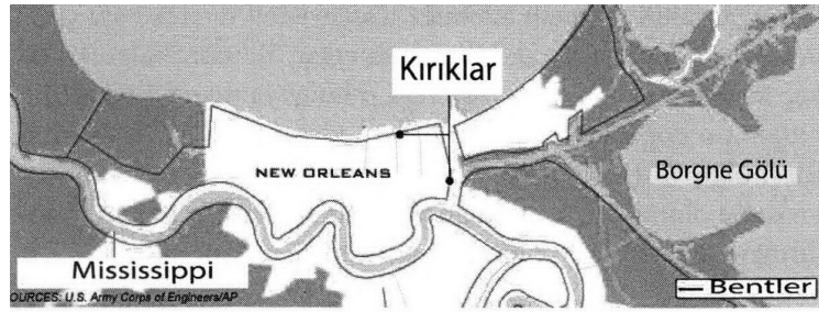
Şekil 2 New Orleans şehrini koruyan bentler ve bunların Katrina Kasırgası esnasında kırıldığı iki yeri gösteren harita.
